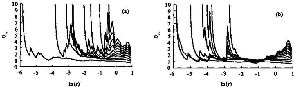
图 3 无噪声情况下长度为(a) 50; (b) 100 的 Henon 映射序列的关联维 Takens-Theiler 估计
