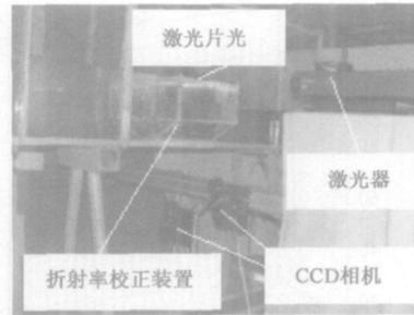
图7 三维PIV试验现场布置图
