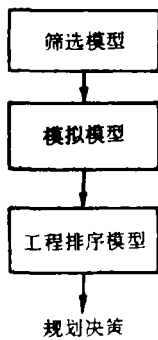
图1 阿根廷科罗拉多河流域规划混合模型结构
