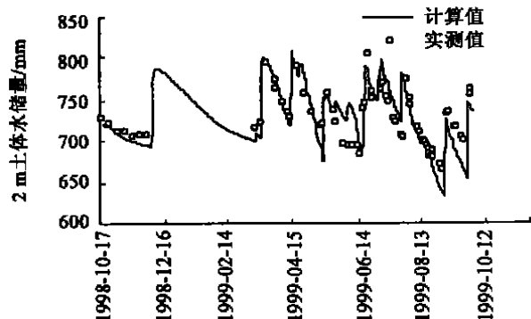
图 2 用动力学模型计算的 C 剖面 2 m 土体水储量计算值与实测值比较
