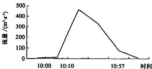
图1 四棵树河1984年12月17日冰洪流量过程线
