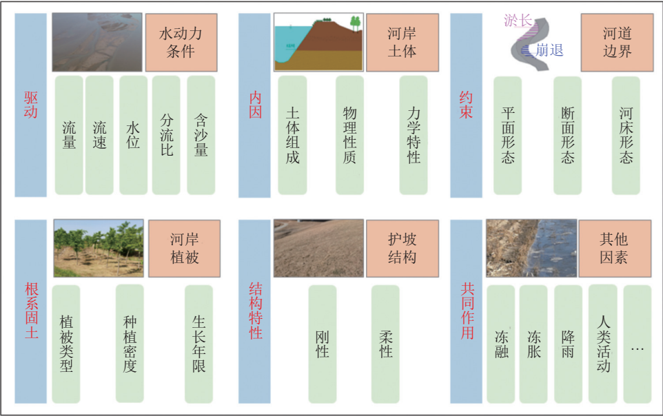
图 2 典型生态护坡冲刷破坏影响因素
